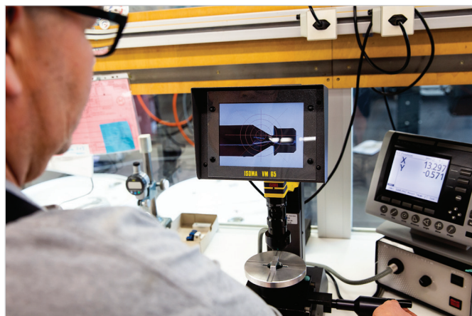
Rozměry medicínských komponent se kontrolují na mikroskopu. (Zdroj: Horn)
