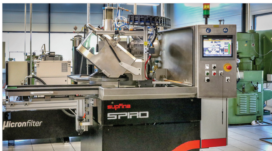
Nový brousící stroj Supfina Spiro F5 slouží při výrobě mikrokomponeutů ve společnosti MPS. (Zdroj: Supfina)
