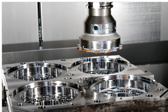
Skříň upínacího pouzdra z materiálu 1.2312 (40CrMnNiMo8-6-4) se obrábí výstružníkem URMA RX o průměru 108 mm.
