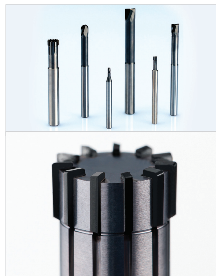
Nástroje s CVD-D břity nabízejí nové možnosti obrábění slinutého karbidu.
