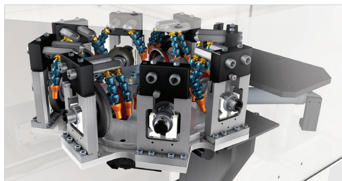
Měnič pro osm sad brusných kotoučů kombinovaný s vyměnitelnými tryskami chladicí kapaliny
