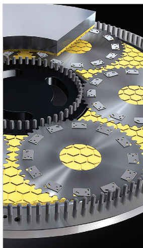
Princip finišování povrchů, jemného broušení a oboustranného broušení
