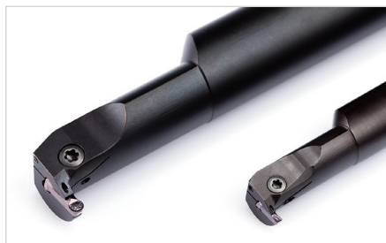
Držáky systémů 209 a 216 nabízejí dobré tlumicí vlastnosti i vnitřní převod chlazení.
