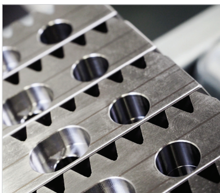
Ozubené tyče po dokončení otvorů
