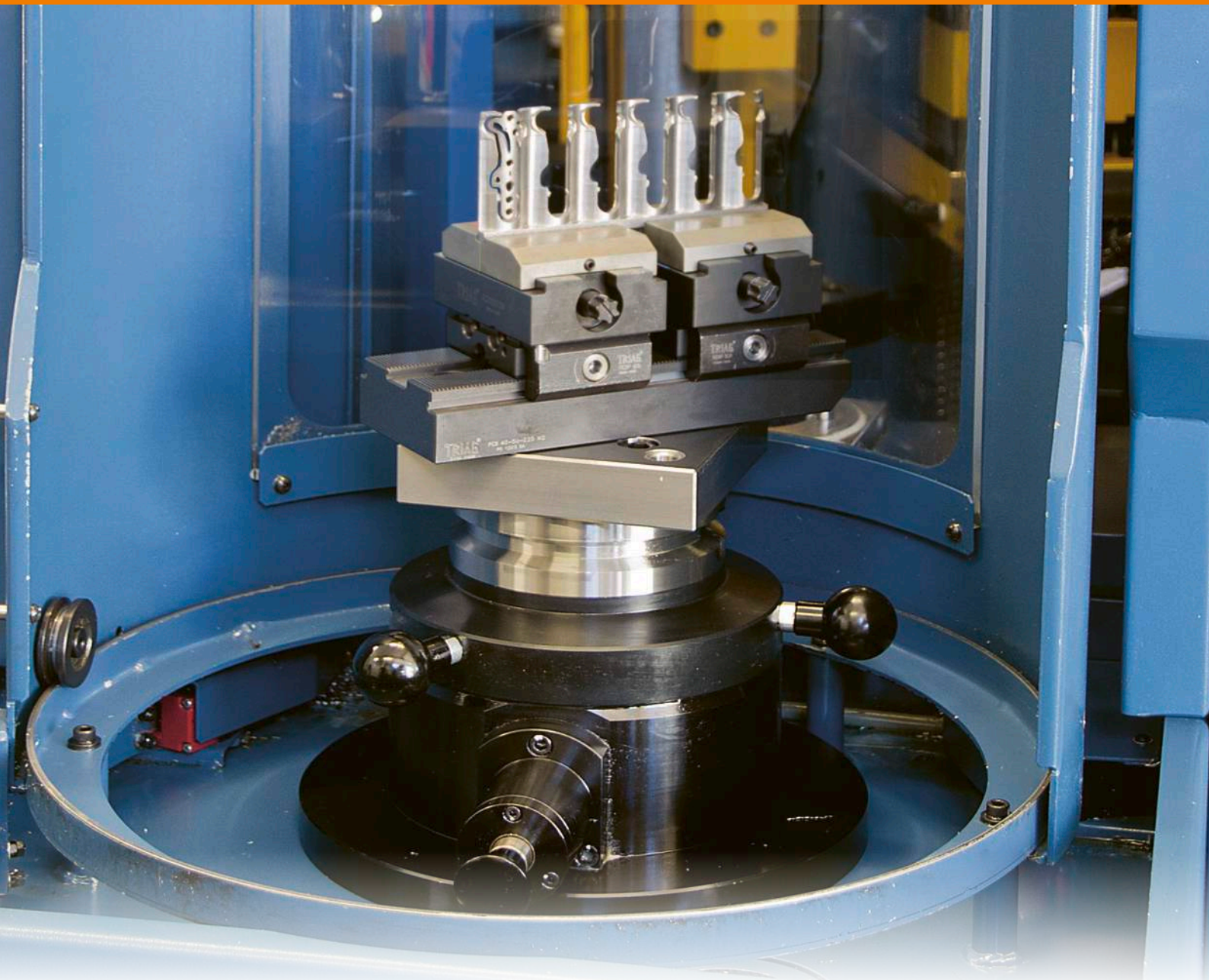
Zwei Mini - Zentrischspanner mit Direktprägebacken halten verschieden lange Titanbleche. Um die verschiedenen Längen zu adaptieren, können die Spanner in 2 mm schritten seitlich versetzt werden.
