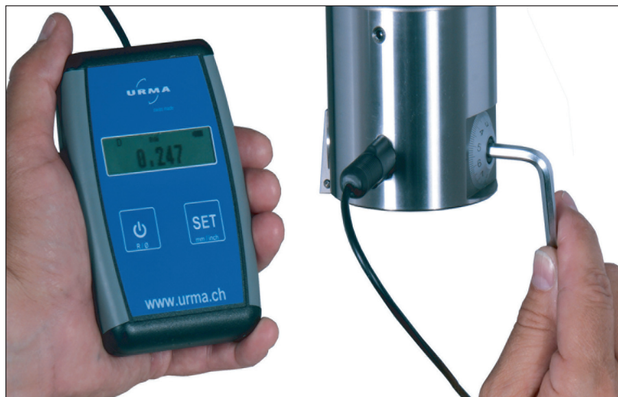
Přestavení digitální vyvrtačací hlavy s přesností na 1 \mu\text{m}
