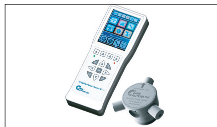
Přístroj GFT-X pro měření upínací síly
