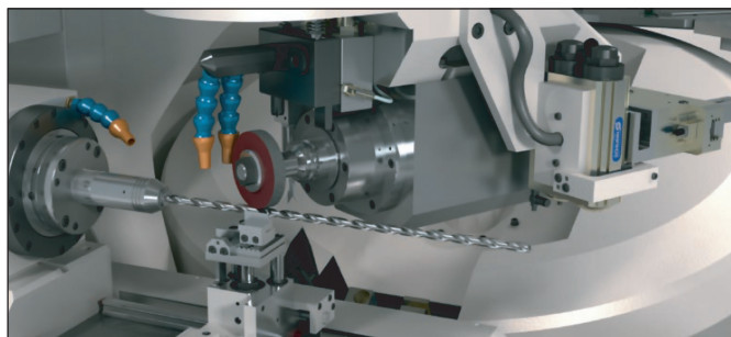
Broušení dlouhých nástrojů s CNC lunetou na stroji UW I G
