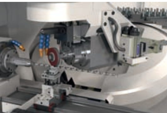
UW I G – broušení dlouhých nástrojů s CNC lunetou
