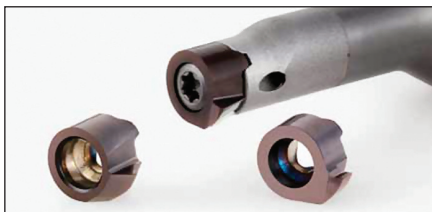
Břítová destička Mini 106 pro vnitřní zapichování a soustružení od \varnothing 6 mm
