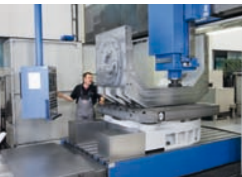
FIBROMAX – přesné polohování obrobků o hmotnosti až 140 t
