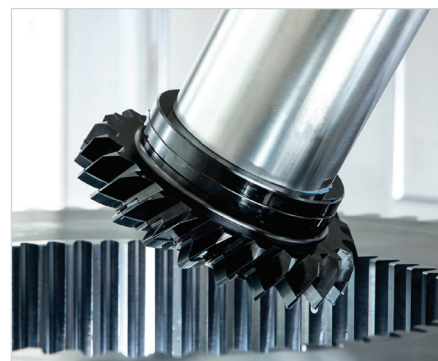
Výroba ozubení metodou power skiving (Zdroj: Horn)
